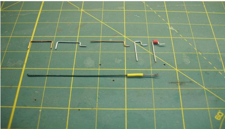
Diese Hangriffe und Stoßstangen werden auf die Stirnseite montiert.
