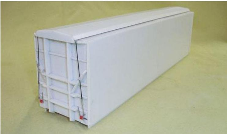
Als alle Messingteile montiert sein kann das Gehäuse und das Rahmen grundiert werden.
