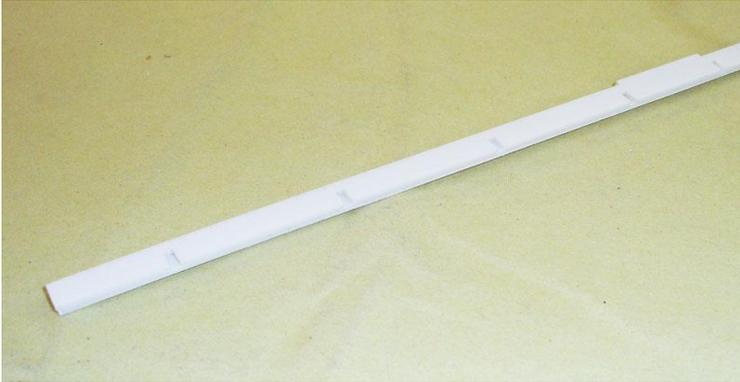
Diese Längsträger werden in die Aussparungen von der Bodenplatte eingeklebt.
